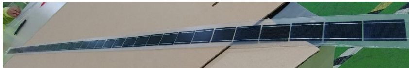
Figura 5: Módulo fotovoltaico de 36 celdas de silicio monocristalino de 4.14 cm X 5.29 cm conectadas en serie con dos busbars.
